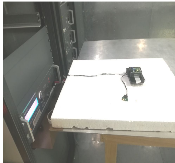
Fotos 17 e 18 – Imunidade a Transientes Elétricos Conduzidos referente aos pulsos 1, 2a, 2b, 3a, 3b, 4
