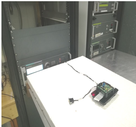
Fotos 17 e 18 – Imunidade a Transientes Elétricos Conduzidos referente aos pulsos 1, 2a, 2b, 3a, 3b, 4
